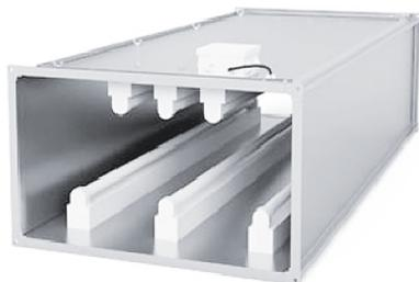
Секция бактерицидная предназначена для обеззараживания воздуха ультрафиолетовым излучением непосредственно в канале воздуховода. Секция монтируется в любом положении. Корпус изготавливается из оцинкованной стали. В качестве ламп применяются бактерицидные газоразрядные ртутные лампы низкого давления мощностью 75 Вт (питание 230В).
