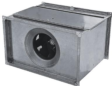
Канальный вентилятор SVPS предназначен для перемещения воздуха и других невзрывоопасных газовых смесей. Вентилятор устанавливается непосредственно в прямоугольный канал систем и используется как для внутреннего так и для наружного применения в условиях умеренного климата. Допустимая температура перемещаемого воздуха от -30 до +40°C. В стандартном исполнении вентилятор изготовлен из оцинкованного стального листа. Рабочие колеса вентилятора статически и динамически отбалансированы. Диффузоры
