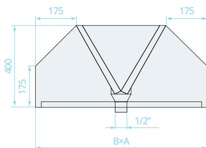
Зонты приточно-вытяжные серии ЗПВО устанавливаются над тепловым оборудованием для улавливания избыточного тепла, влаги, жировых испарений и продуктов сгорания с притоком свежего воздуха для улучшения микроклиматических условий в рабочей зоне горячих цехов на предприятиях общественного питания, ресторанах, столовых, кухнях и т.д.
